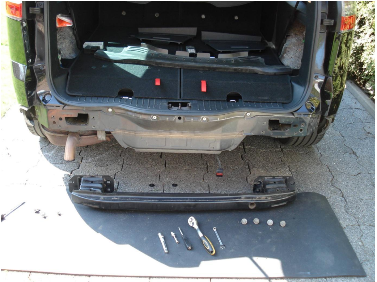
Der demontierte Stahlträger / Aufprallschutz.
