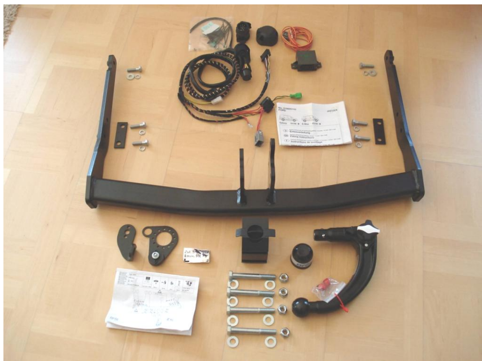
Das komplette Set: Oris/Bosal abnehmbare AHK inkl. Jäger E-Satz
